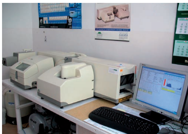
Laserowy miernik wielkości cząstek, fot. archiwum OSCh-R w Olsztynie
